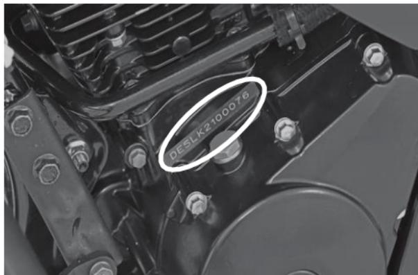
El número de motor está ubicado en la carcasa izquierda del motor, cerca al cilindro.
